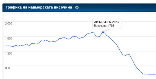
Фиг. 6. Запис на отчетената надморска височина в полет на парапланер - GPS тракер Atrack AT-1
